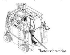
Colhedora de cana-de-açúcar: equipamento que permite a colheita de cana de modo uniforme, por
